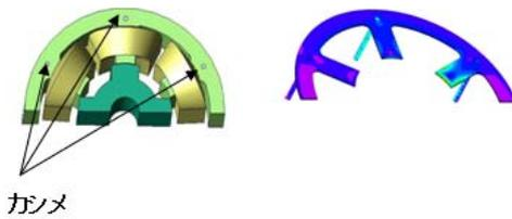
図8 打ち抜きまたはカシメによる積層間渦電流の図
