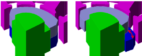
図 13 磁石間のスキュー角を変化させたパラメトリック解析
