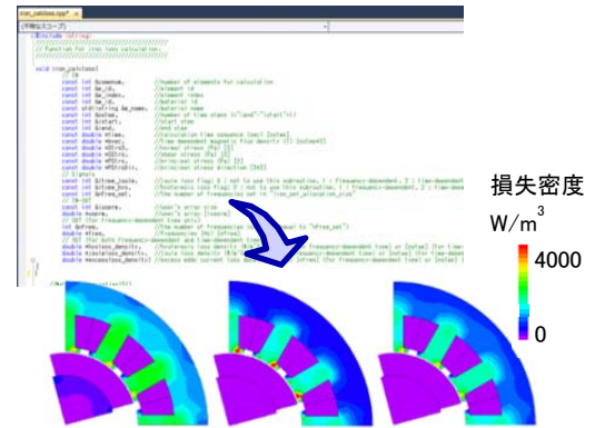
図 12 鉄損計算手法のカスタマイズ例
