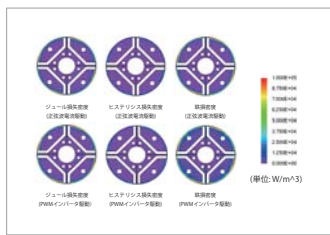
図5 ロータコアの損失密度分布
